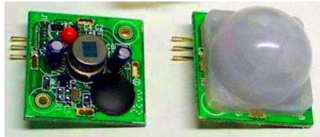
Fig: PIR Sensor
